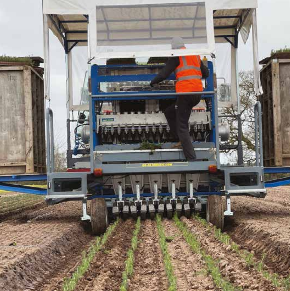
Plantmachine van TTS verwerkt papierpot-pluggen van OptiPlug
