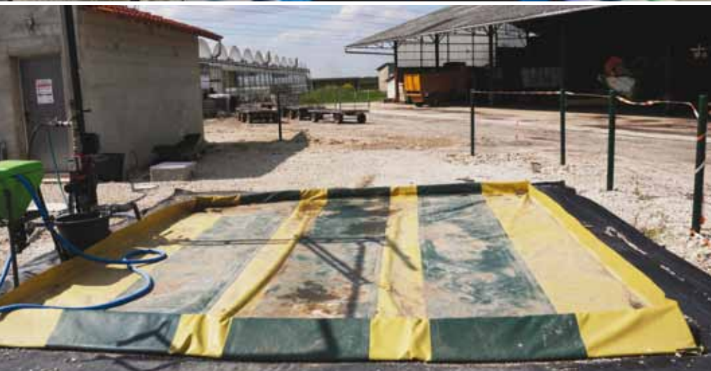
Het ziet er enigszins klungelig uit, maar het zou volgens Croux wel goed werken. Op de mat worden spuitmachines schoongemaakt. De spuitvloeistof wordt vervolgens gereinigd en 'ingedikt' in een aparte installatie.
