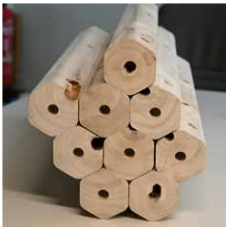
WeGrow ontwikkelt in samenwerking met marktpartijen concepten om het hout toe te passen in de bouw. Hier drie tot vier jaar oude stammen die hexagoon geschaafd zijn en met duvels verankerd.
