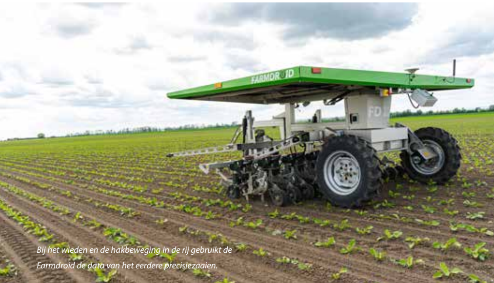
De Farmdroid haalt zijn energie uit het zonnepaneel, is geschikt voor oppervlakten tot 20 hectare en werkt zonder toezicht.
