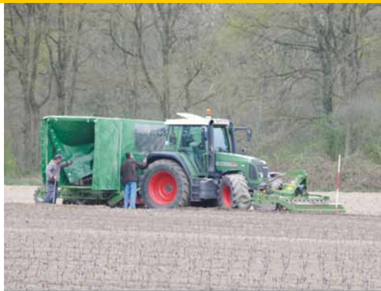
Planten gebeurt met een tractor met voorop een rotorkoepel en achterop de plantenploeg.
