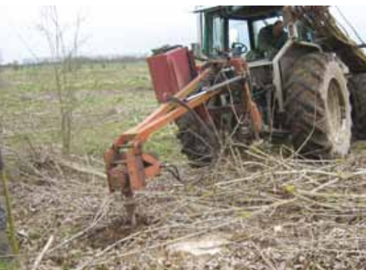
Gaten boren, een meter diep voor de stekken.
