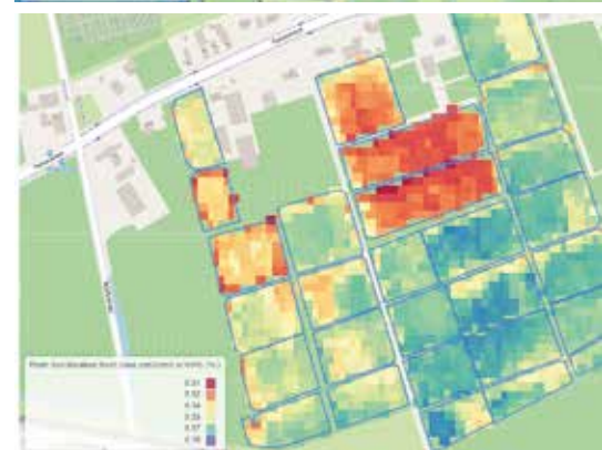
Boven: kaart van boomgaard 't Hofke met gewastemperatuur op 7 augustus 2022. De afmetingen van elke pixel bedragen 10 m bij 10 m. De bomen op 27 graden hebben de beste drogestofproductie (165 kg/ha/d). Het vochtgehalte in de bodem wordt afgeleid van de temperatuur. Onder: kaart van het bodemvochtgehalte op 9 februari 2022 op de kwekerij van Volentis.
