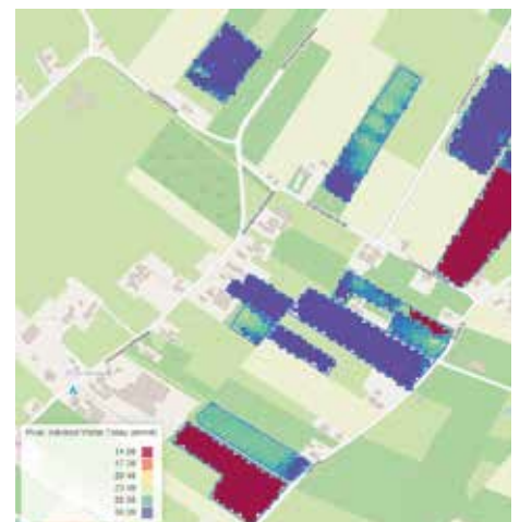
Dagelijks beregeningsadvies voor boomkwekerij De Vree, hier op 2 augustus, een droge en warme dag. Sommige velden hebben 14 mm nodig, andere 30 mm. Enkele velden krijgen een variabel advies. Door een veld in sectoren in te delen, kan variabel worden berekend en dus op energie en water worden bespaard.
